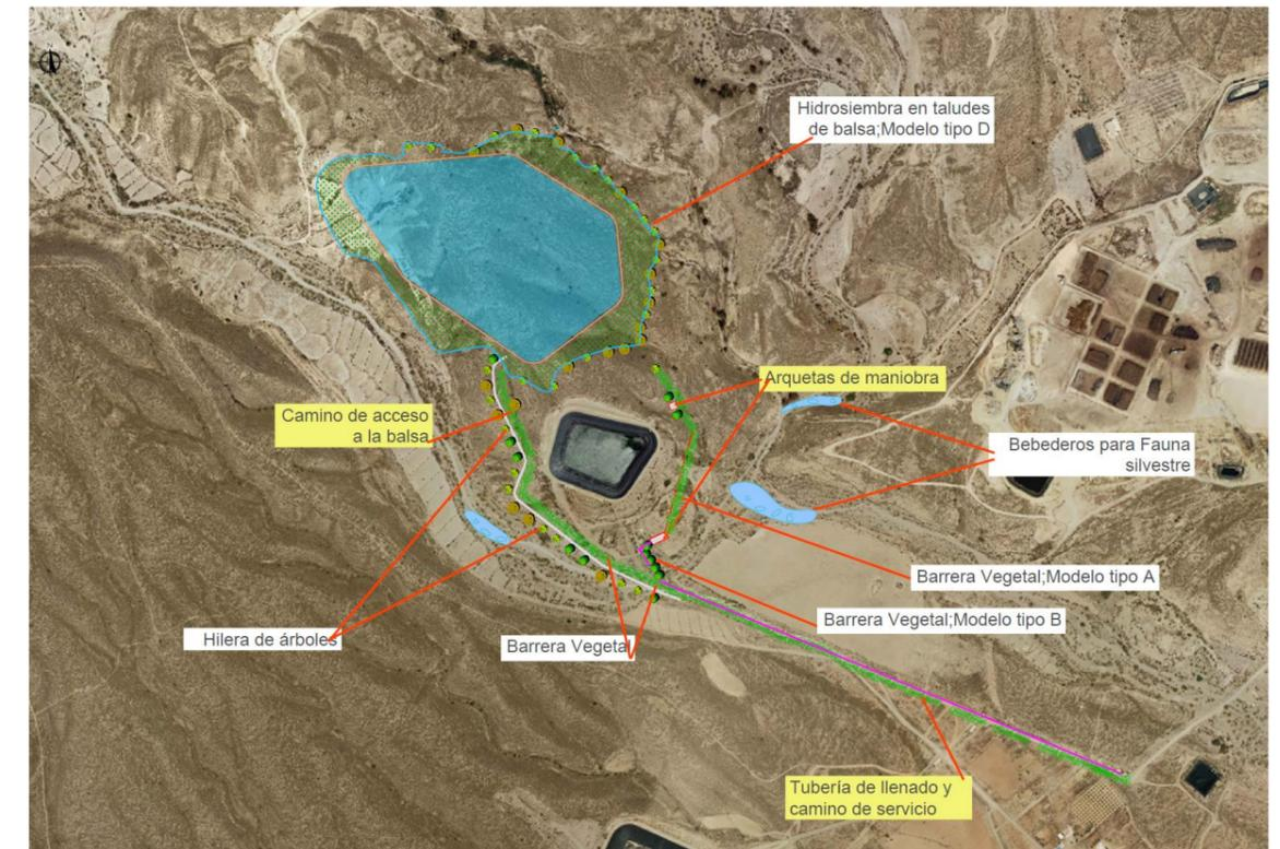
Fig. 1. Replanteo medidas correctoras. Implantación zona balsa (plano 14 hoja 1/4)
