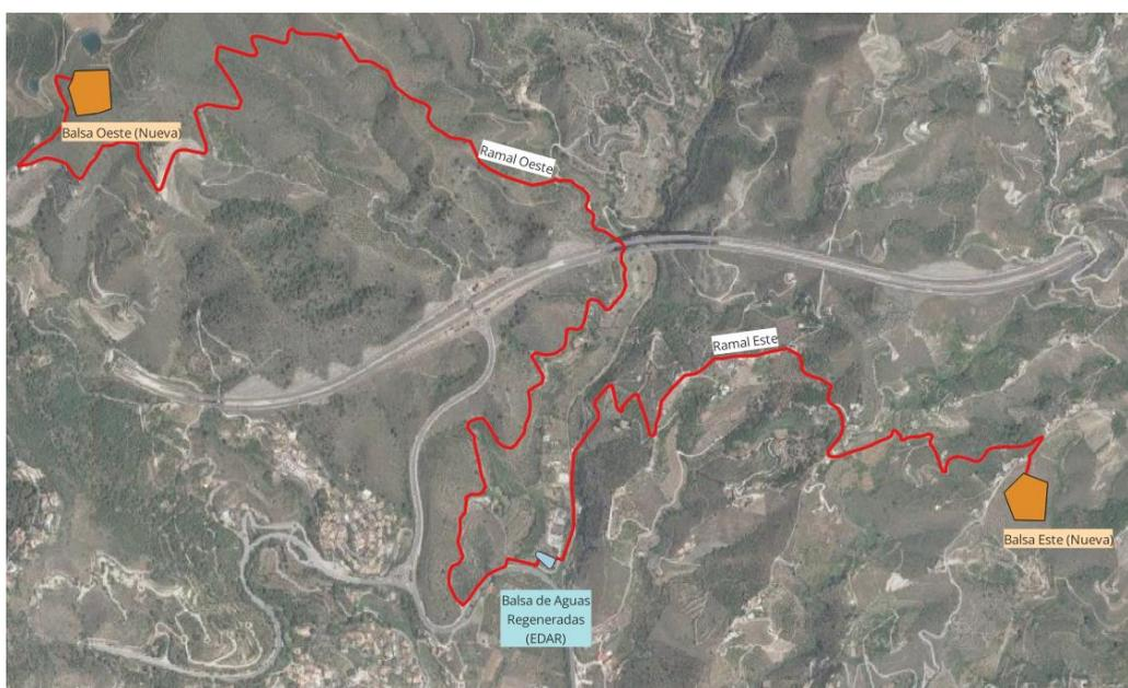
El Ramal Oeste partiría hacia el sur de la EDAR discurriendo brevemente por la vía de acceso a la EDAR (paralela a la carretera N-340), para posteriormente tomar el camino de la margen derecha del río Jate, pasando bajo el viaducto de la A-7. Pasados 300 metros del viaducto, el trazado abandona la carretera asfaltada subiendo la ladera por distintas aristas hasta alcanzar el conocido como “Camino del Agua” y desde este acceder a la pista del Cerval, donde se encuentra la balsa destino.
