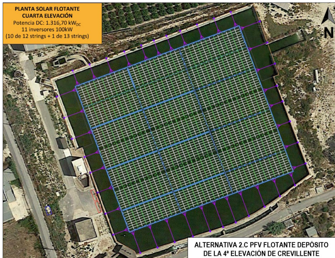
Ilustración 15: Plataforma de la PFV flotante de la 4ª elevación de Crevillente sobre el depósito existente
