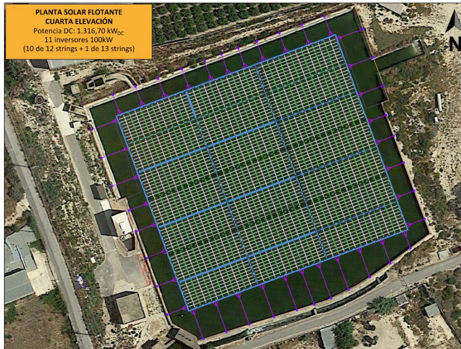
Ilustración 9: Diseño de la PFV de la 3ª elevación de Crevillente sobre el depósito.
