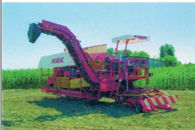
Sacudidor de rayo vibrante o sacudidor alternativo.
